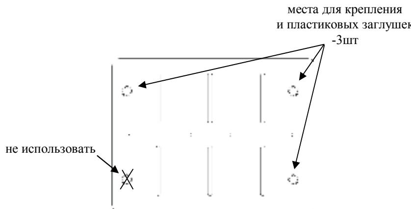
Рис. 3 Крепление корпуса прибора на стене
